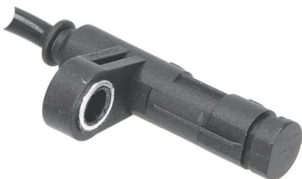
ABS-givaren som läser av hjulets hastighet via polhjulets magnetism
