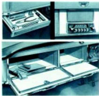
The glove box lid opens to the instrument position to form a useful table. Obs, två färgpennor i verktygsskrinet på de tvåfärgade modellerna
